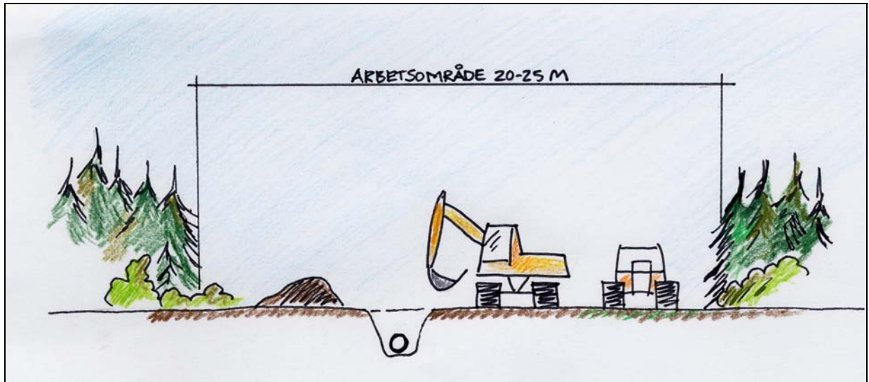
Figur 3 4. Ledningsförläggning i skogsmark.
