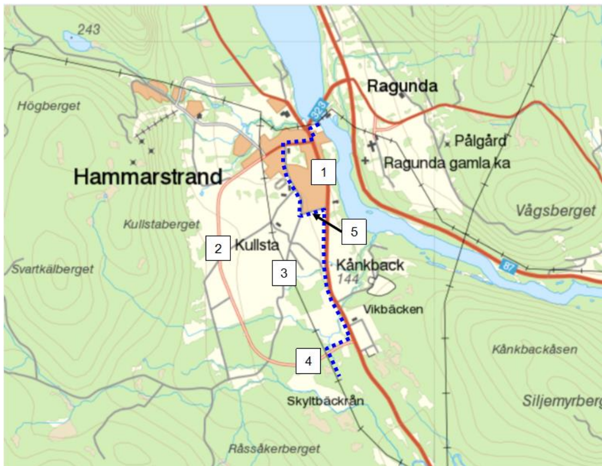
Figur 5: Andrahandsalternativ avseende sträckning och utformning. Blå streckad linje utgör sträckning för planerad markkabel. Rutor med siffror markerar de olika vägar som anges i den beskrivande texten.
