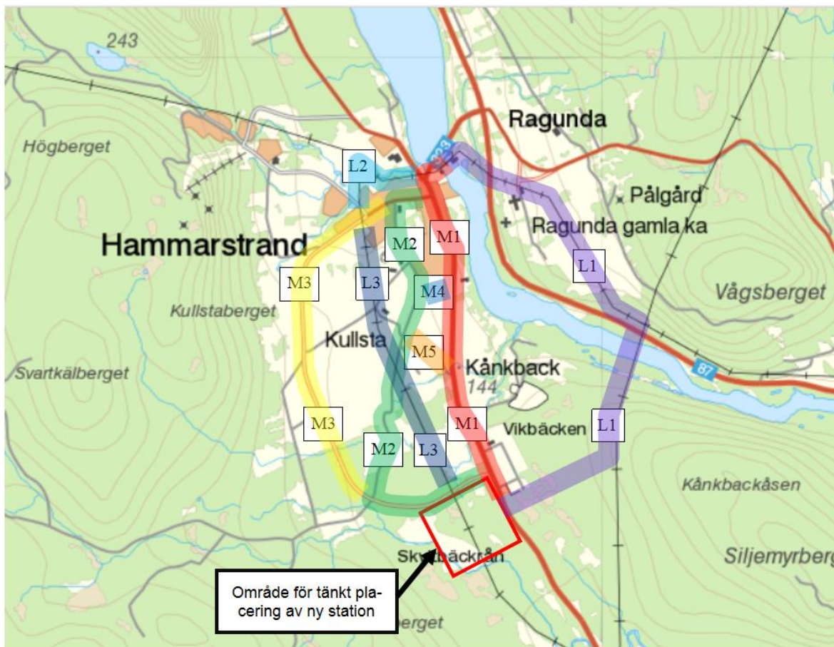
Figur 3: Undersökta alternativ avseende sträckning och utformning. Benämningarna på de olika alternativen är angivna med L för luftledning eller M för markkabel.
