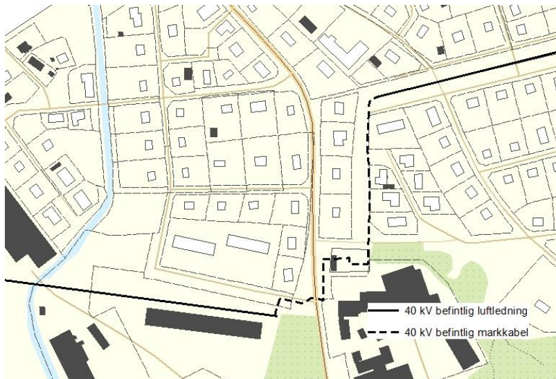
Figur 2.1 Karta med befintlig ledningssträcka.
