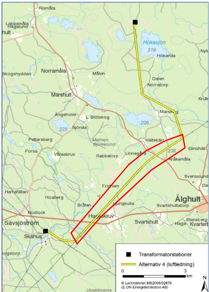
Figur 3. Karta över alternativ 4. Inom rödmarkerat område sträcker sig alternativet parallellt med Svenska kraftnäts befintliga 400 kV ledning.
