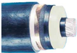
Figur 3. Enfasledare för markförläggning. Innerst en ledare av aluminium. Utanför ledaren isolation av PEX samt ytterst ett skyddshölje av polyeten. Källa: ABB.
